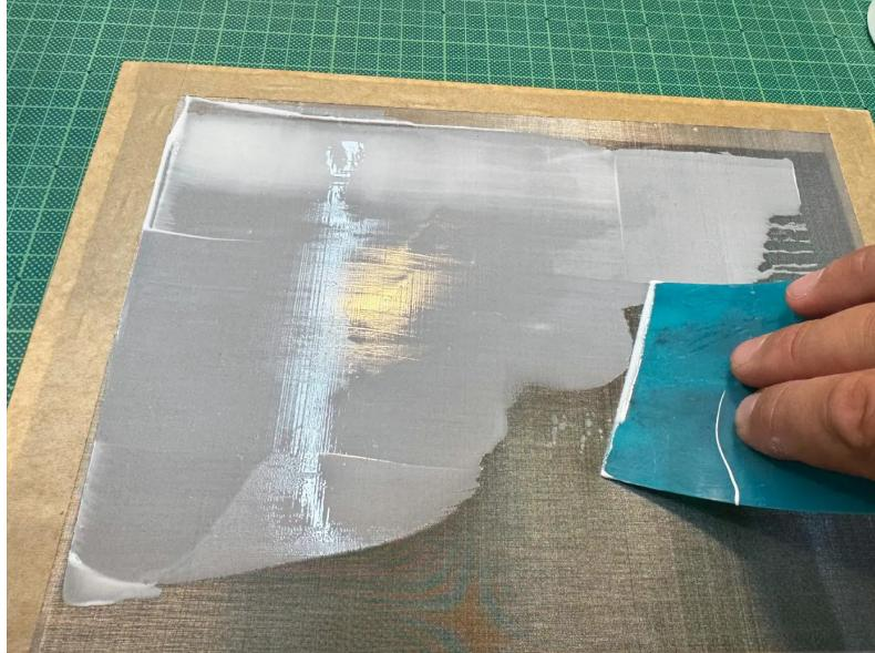
Mit wasserfestem Holzleim werden die Öffnungen des Siebes verschlossen. Der Kunststoffspachtel schont das Gewebe und dient später auch als Rakel zum Drucken.
