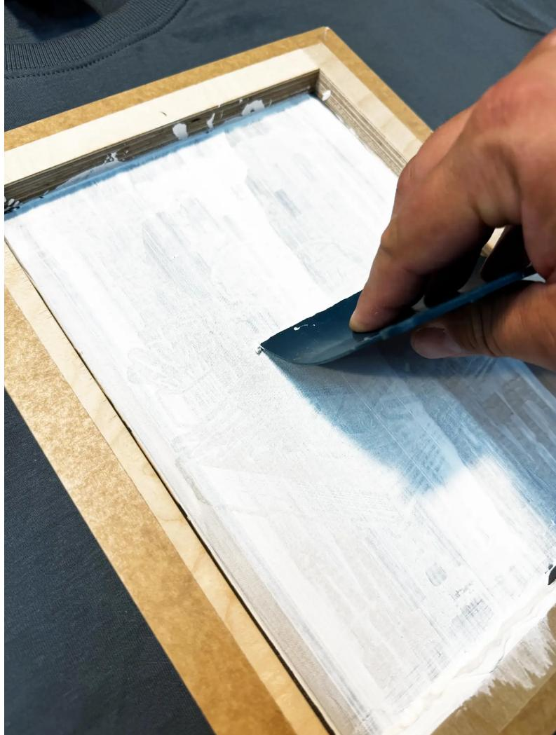
Wenn die Farbe mit dem Spachtel über das Sieb verteilt wurde, kann sie im zweiten Durchgang mit moderatem Druck durch das Sieb hindurch auf den unter dem Rahmen liegenden Stoff gedrückt werden.
