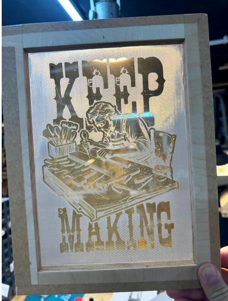
Dieser Siebdruckrahmen ist druckreif. Das Motiv hat der Laser freigelegt. In den dunklen Bereichen ist das Sieb also wieder für die Druckfarbe durchlässig.
